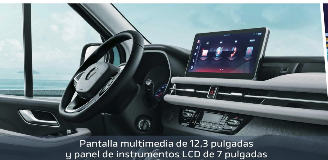
Pantalla multimedia de 12,3 pulgadas y panel de instrumentos LCD de 7 pulgadas
